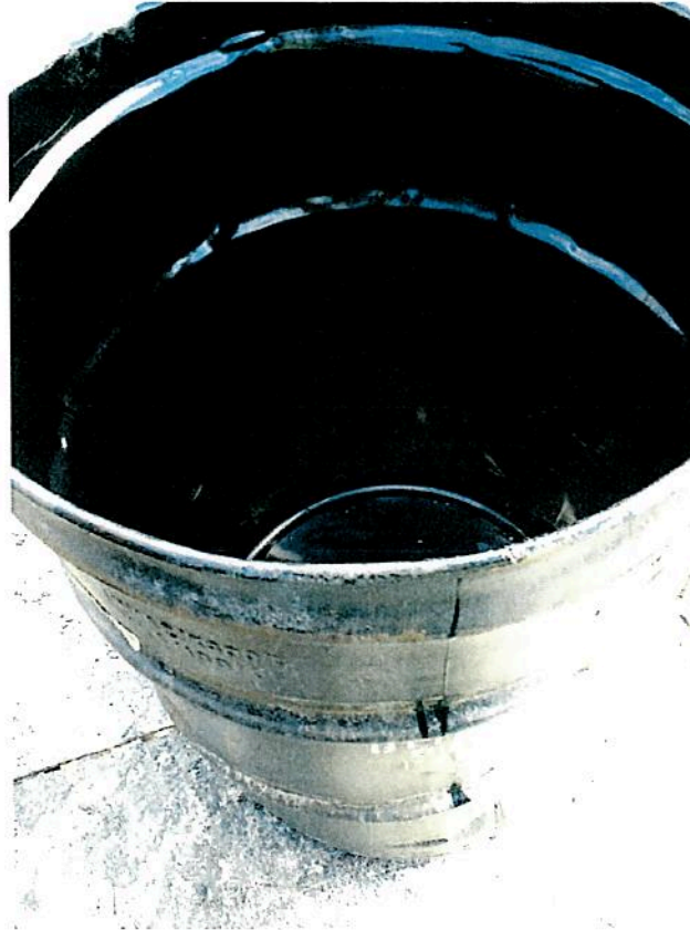
Figure 1 : Baril vide et propre à la sortie du four
