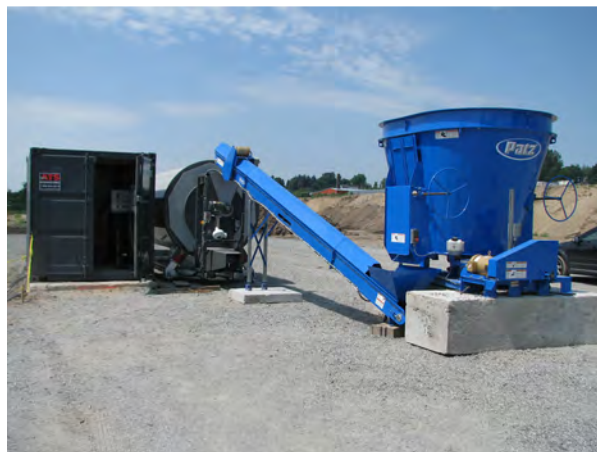
Figure 8 : Photo d'un convoyeur reliant un mélangeur à un composteur.
