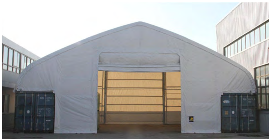
Figure 11 : Exemple de mégadôme installé sur des conteneurs, avec une ouverture frontale.
