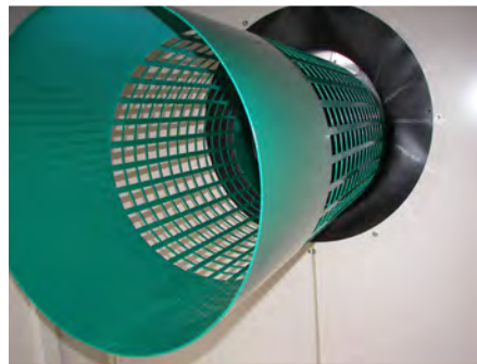
Figure 13 : Photo du tamis installé à la sortie du composteur.
