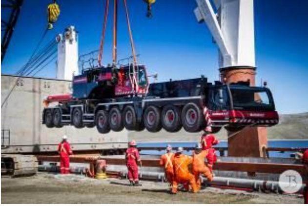
Déchargement d'une grue 800 tonnes à partir d'un navire au Nunavik
